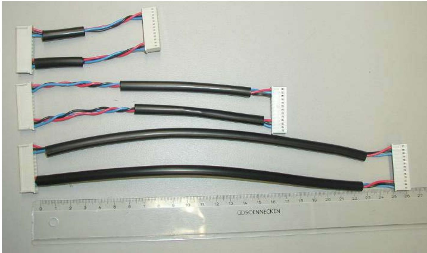
注释：并联驱动IGBT连接电缆推荐尽可能相同和较小回路面结；
