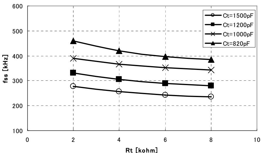
\* C<sub>t</sub>: FBL端子に接続する外付けコンデンサ
