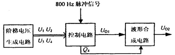
图 2 阶梯波产生电路框图
