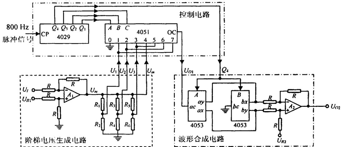
图 3 阶梯波产生电路
