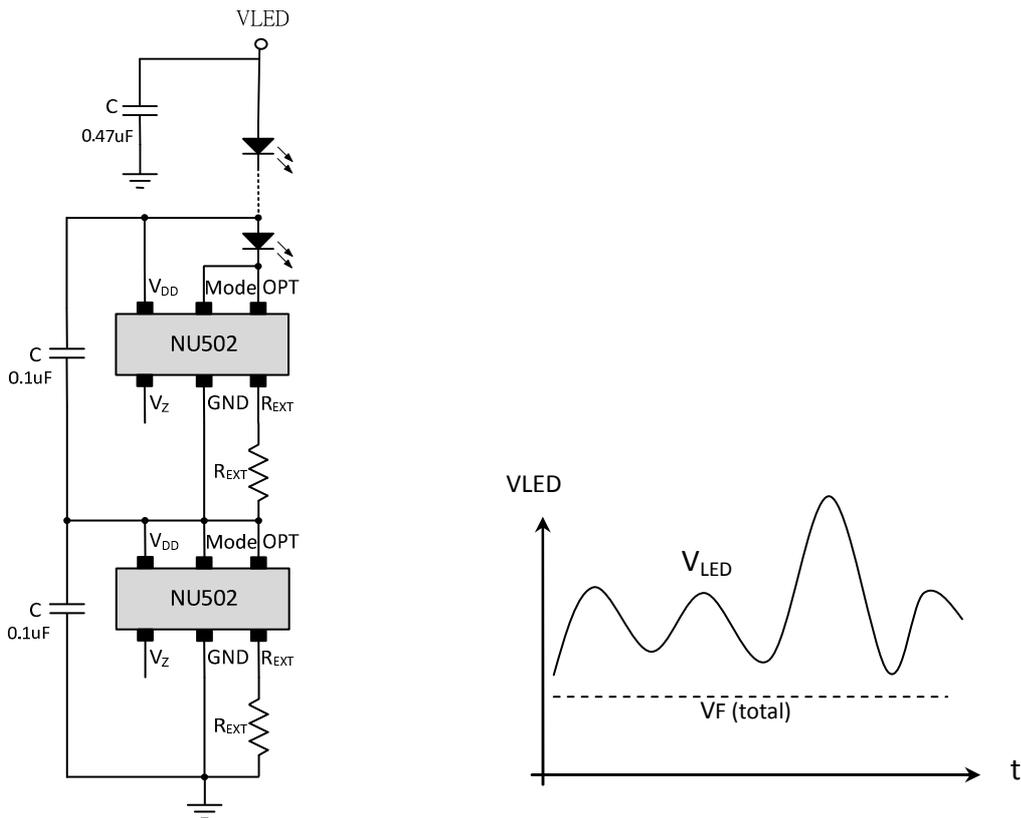
在串接模式下，使用兩個或更多的 NU502 串接能吸收更高的輸入電壓的變化。在照明系統中，每一顆 NU502 可以承受約 12V 左右的電壓。由下面的公式可計算出系統可以工作的總電壓的變化範圍。
